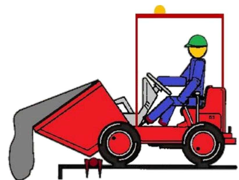
Utiliza topes para el vertido en zanjas y taludes
